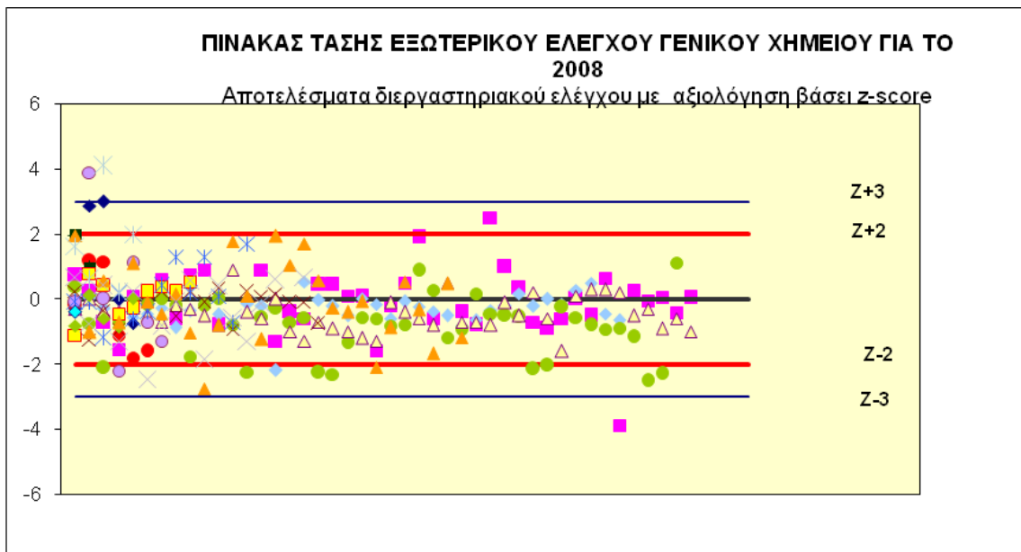
Σχήμα (1): Διάγραμμα τάσης εξωτερικού ελέγχου Γενικού Χημείου για το 2008. Αποτελέσματα διεργαστηριακών ελέγχων με αξιολόγηση βάσει z-score
